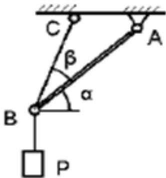
2. Груз весом  $P = 10 \text{ Н}$  подвешен на двух тросах AB и BC, составляющих с горизонтальной прямой углы  $\alpha=15^\circ$  и  $\beta=30^\circ$ . Определить усилия в тросах.
